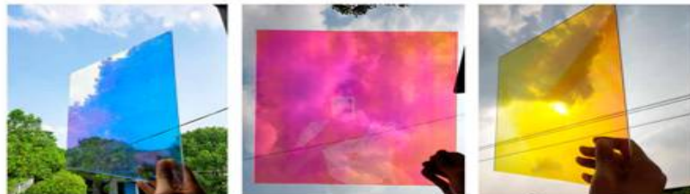
شكل رقم (18) الزجاج المزودج حيث يتغير لونه بتغير الضوء على مدار النهار.
